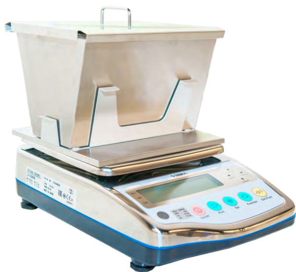
Весы серии CJ с корзиной для взвешивания живого веса
