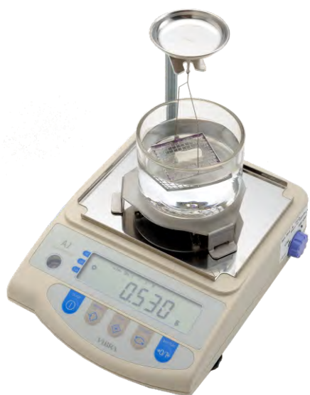
Весы серии AJ с комплектом для измерения плотности
